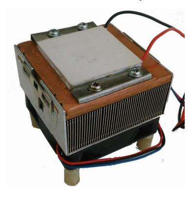
Nous avons fabriqué 2 pontets en tôle d'acier, chacun étant maintenu fermement par 2 vis de 3 mm dans la plaque de cuivre (voir photo).
